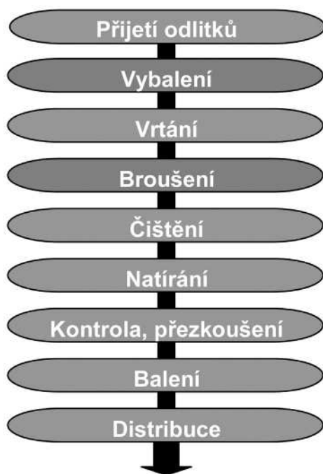
Obrázek 3: Procesní schéma strojírenské výroby (viz příklad)
