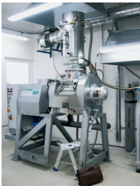
Obrazek 1: Jednotka termické desorpce v technologické laboratoři Slaný
