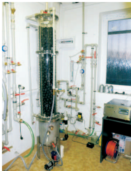
Obrazek 2: Zařízení pro čištění odpadních plynů
