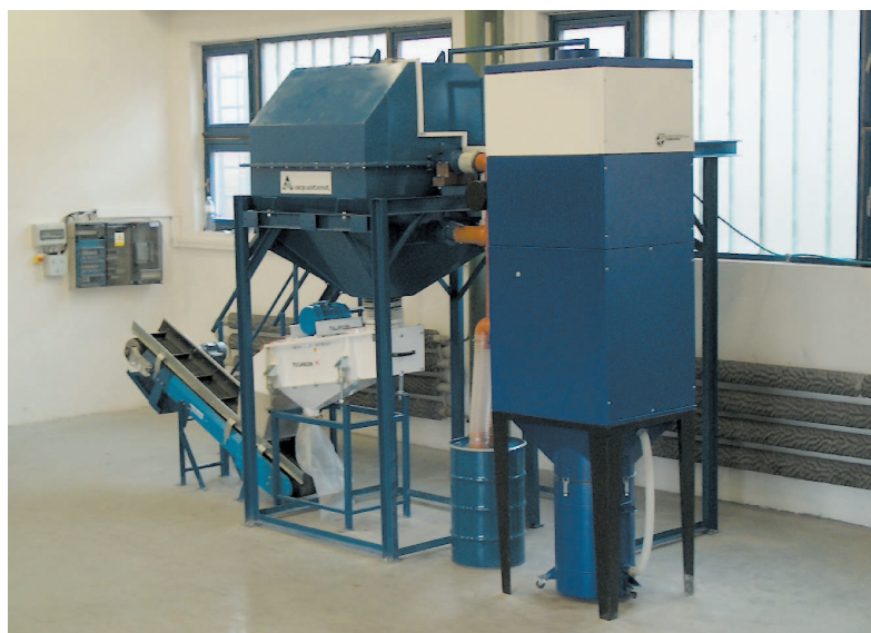
Obrázek 3: Diskontinuální linka na čištění skloviny
