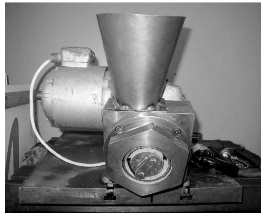
Obrázok 1: Funkčný model novej konštrukcie peletovacieho stroja
