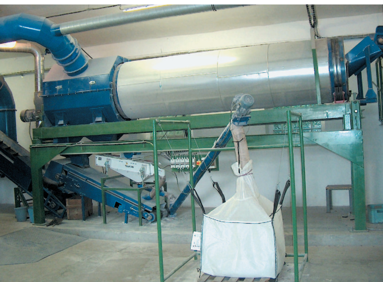
Obrázek 1: Kontinuální linka na čištění skloviny
