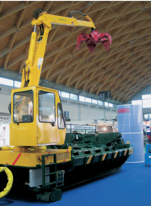
Obrázek 1: Kontejnerový lis a jedno z četných zdvihacích zařízení pod klendbou z lepených dřevěných nosníků
