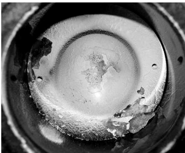
Obrázek: Úsady \text{SiO}_2 na stěně pístu motoru po cca 5000 hod. provozu
