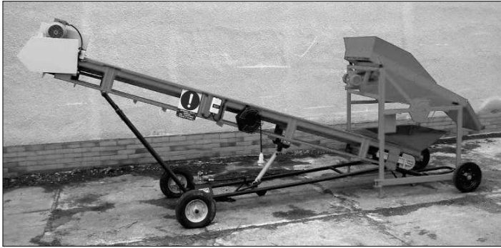
Obrázek 1: Vibrační třídič s rovinným sítem VSD-01 s vynášecím dopravníkem
