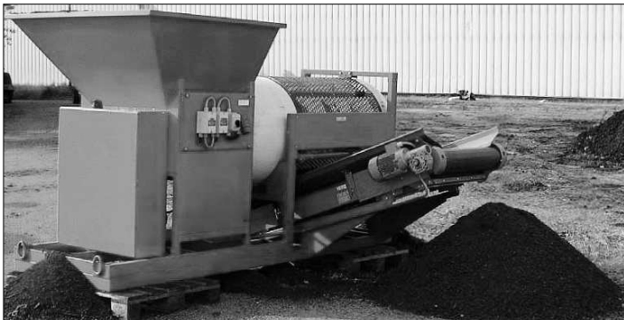
Obrázek 2: Rotační třídič s válcovým sítem RVS 01
