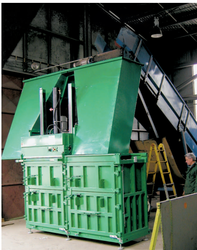
Obrázek 1: Lis L30-2 se dvěma komorami a plněním zhora dopravníkem
