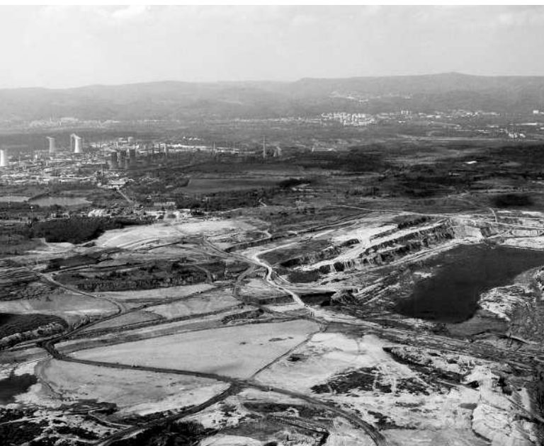
Obrázek 1: Letecký pohled na prostor budoucího jezera Most. V levé horní části obrázku je vidět areál společnosti Chemopetrol, kde souvislá plocha na jeho východním okraji představuje zatěsněné sektory popelových skládek.
