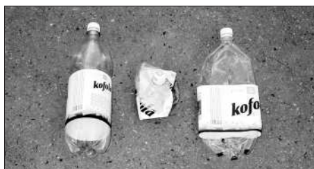
Obrázek 3: Dvoulitrové PET lahve před zkouškou a po zkouškách
