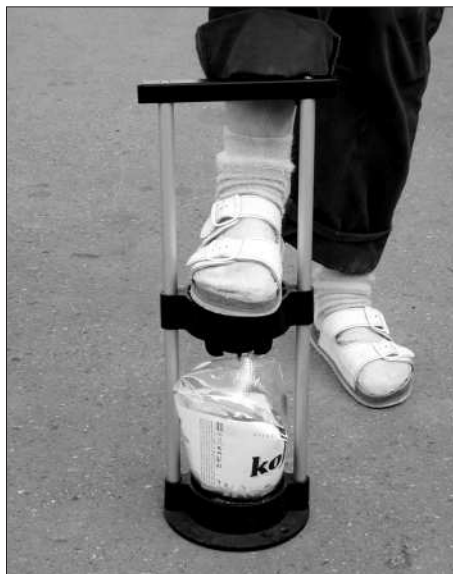
Obrázek 2: V přípravku se objem PET lahve zmenší až 7krát
