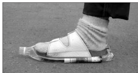
Obrázek 1: Sešlápnutím se zmenší objem dvoulitrové PET lahve 5,3krát
