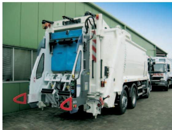
RR Olympus 23W/ MB Eonic = podvozek CNG, automatický vyklápěč TERBERG
