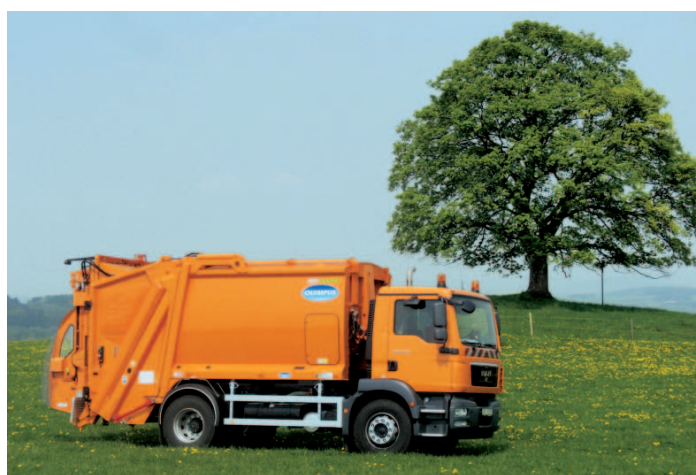
RR Olympus 23W/ MB Eonic = podvozek CNG, automatický vyklápěč TERBERG
