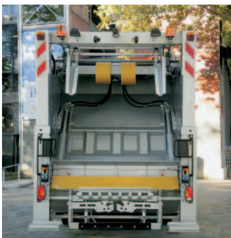
RR integrovaný vyklápeč s nízkou nakládací hranou RCLIF (UPC)
