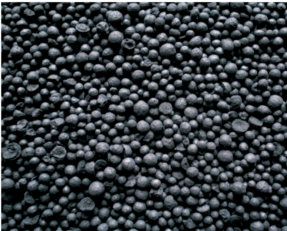
Obrázek 2: Extrudovaný Chezacarb® aditivovaný železem pro zlepšení adsorpce sirovodíku
