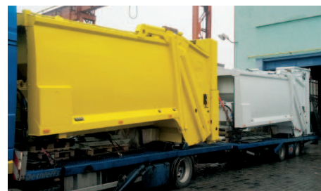
Transport kitů Olympus z výrobního závodu do ČR: obvykle se vezou dva kusy, čímž se optimalizují náklady na přepravu (nahore). Firma HANES má speciální přívěsy pro snadnou manipulaci s nástavbou před montáží na podvozek (dole)
