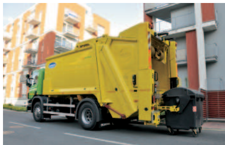
Olympus 16W s otevřeným vyklápěčem Roclift (UPC) na podvozku Scania postavený pro Skládku Vrbička
