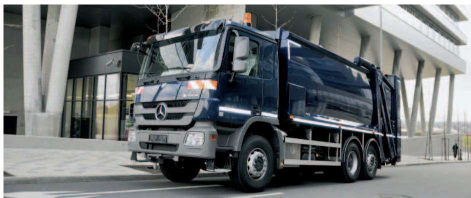
Olympus 20W na podvozku MB Actros postavený pro MPS Kladno. 20 m 3 na tříosovém podvozku je ideální kombinace, standardní rozvor 3,9 m a poslední říditelná náprava, komplet pak disponuje užitečným zatížením 11t!
