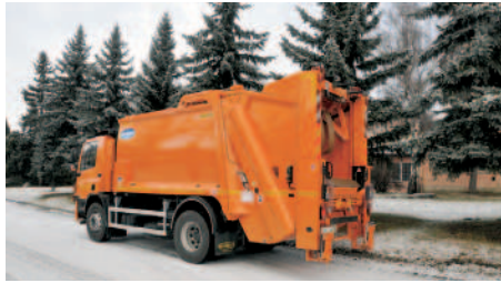
Olympus 14N s otevřeným vyklápěčem Roclift (UPC) na podvozku Daf postavený pro Kralupy nad Vltavou
