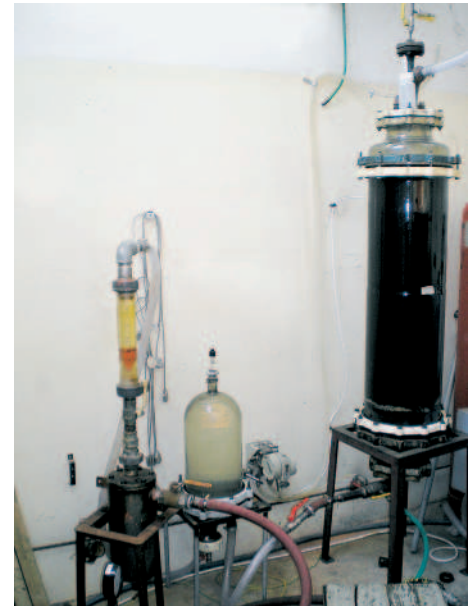
Obrázek 3: Adsorbér pilotní jednotky pro čištění vod z myček aut.
