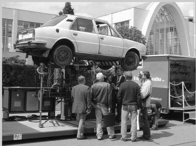
Mobilní zařízení k tzv. vysoušení autovraků rakouské společnosti SEDA Environmental
