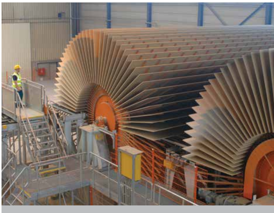
Obrázek 2: Úsek chlazení dřevotřískových desek.
