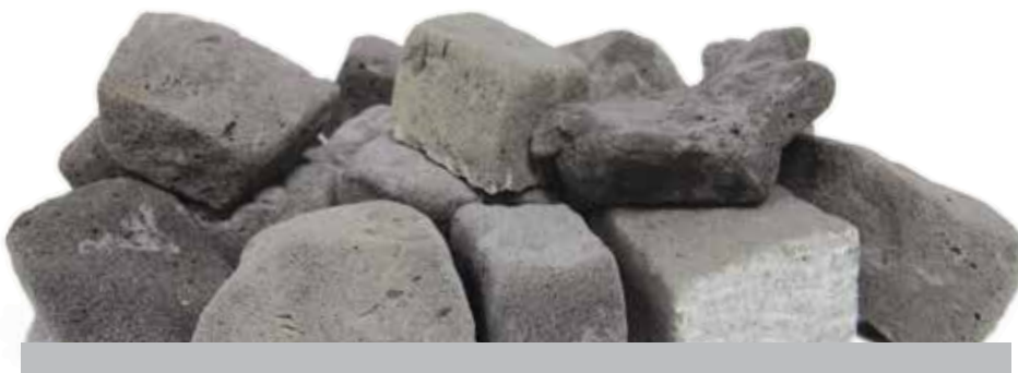
Pěnové sklo se vyrábí z vytríděného skla, resp. ze střepek z vytríděného skla. Ve stavebnictví se používá místo drceného kamene do základové desky.
