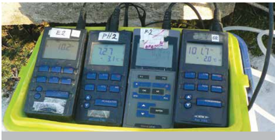
Měření sadou monofunkčních přístrojů se souběžným měřením teploty (zleva ORP, pH, konduktivita, rozpuštěný kyslík).
