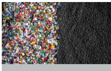
Multigrey regenerulát vyrobený z multicolor plastové drti
