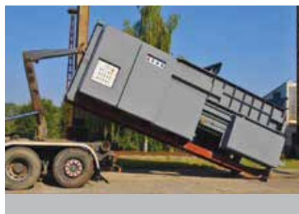
Obr. 1: Mobilní lis na komunální odpad Max Aicher 11kWel. (teor. výkon lisu 120 m 3 /h)
