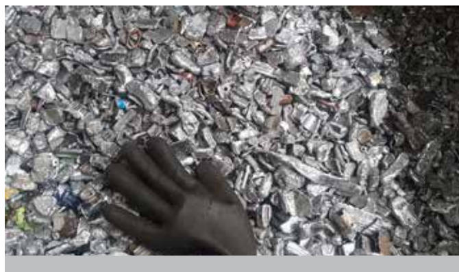
Obrázek 3: Hliníkový výstup z linky Forrec (rozdrcené elektromotory)
