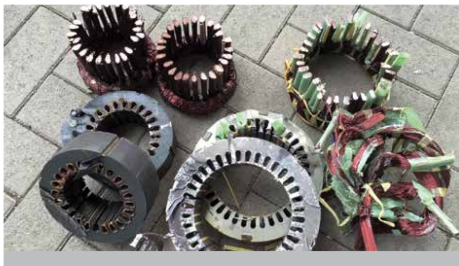
Obrázek 5: Rozebraný elektromotor ze stříhače Bronneberg
