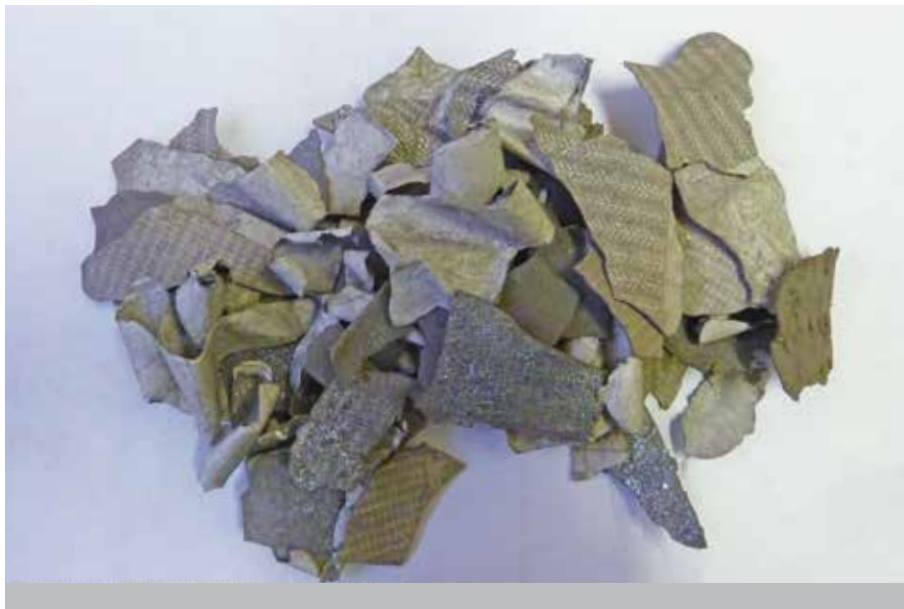
Obrázek 3: Výstup mechanické části recyklace pro následné chemické zpracování (bez skla)
