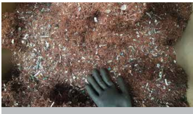
Obrázek 2: Měděný výstup z linky Forrec (rozdrcené elektromotory)
