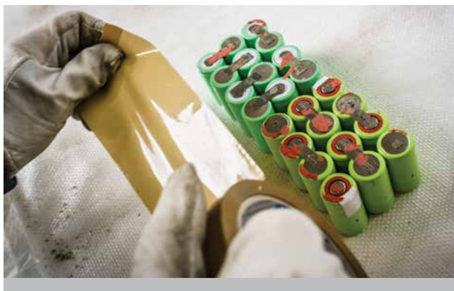
Obrázek 2: Izolace kovových svorek baterií izolační páskou.
