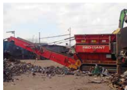
Obrázek 5: Předdrcení lehkého šrotu drtičem Hammel VB 950DK.
