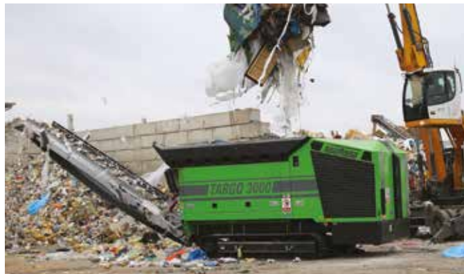
Obrázek 4: Drcení odpadů jednohřídelovým drtičem TARGO 3000, Neuenhauser Maschinenbau GmbH.
