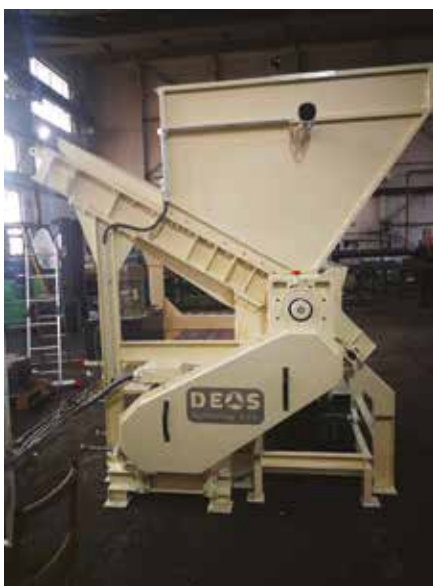
Obrázek 1: Jednohřídelový drtič pro recyklaci hygienických potřeb.
