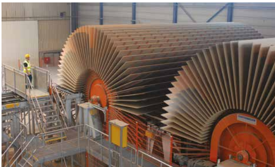
Obrázek 2: Úsek chlazení dřevotřískových desek.
