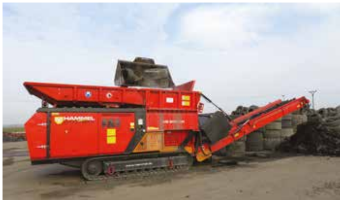
Obrázek 3: Drcení pneumatik dvouhřídelovým drtičem Hammel VB 850DK.
