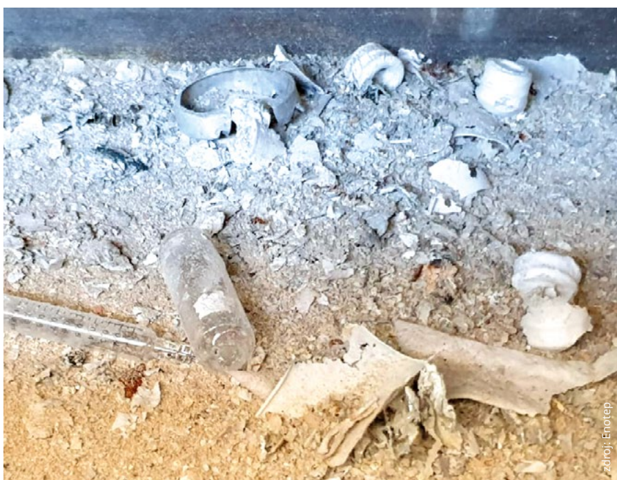
Pevný minerál, který zůstává po suché destilaci obsahující nejčastěji sklo, kovy a minerály
