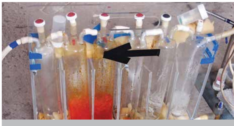
Možné provedení měřicí aparatury obsahu těžkých kovů a rtuť v plynné fázi pro nasazení v terénu
