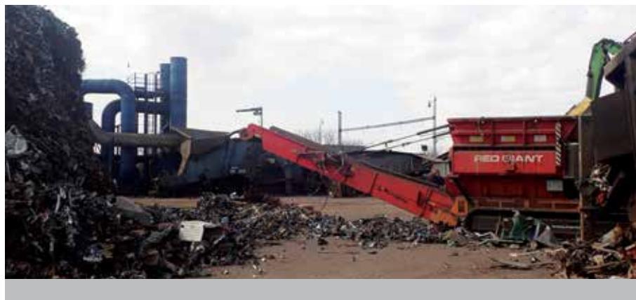
Obr. 3 Předdrcení materiálu na drtiči VB 950.
