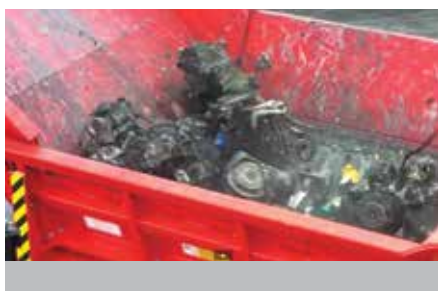
Obr. 2 Zpracování motorů drtičem VB 950 DK.
