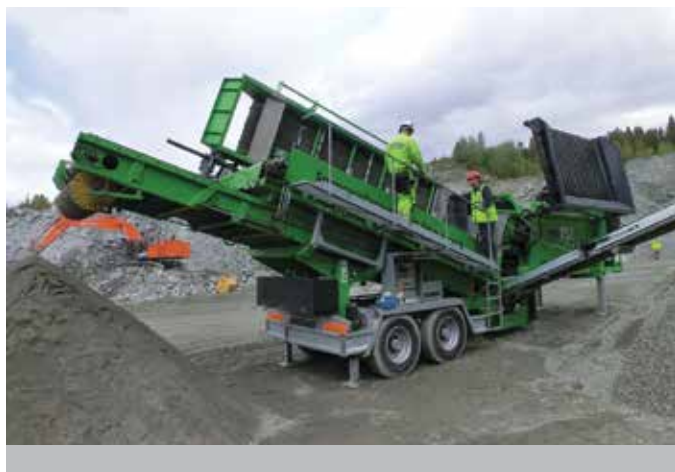
Obr. 2 Spannwellensieb NH 75-2, sklopený dopravník nad síty.
