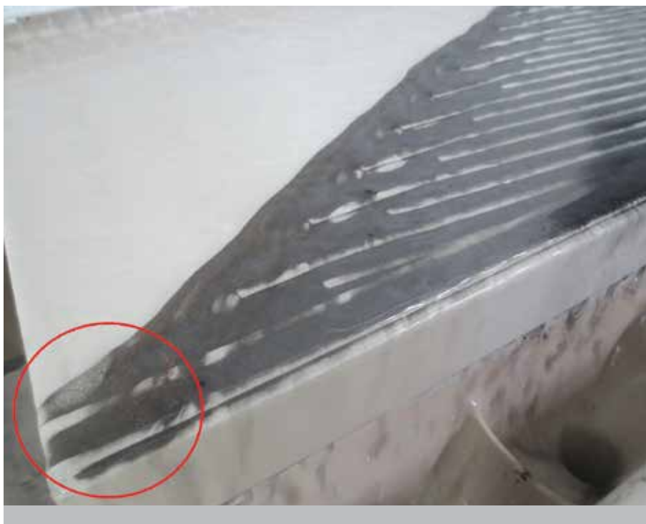
Separace mokrou cestou na vibračním stole (v kroužku označen výstup s obsahem DK).
