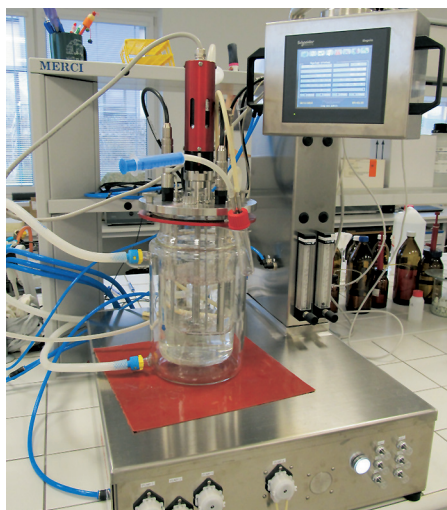
Obrázek 3: Zvětšování objemu inokula v laboratorním reaktoru
