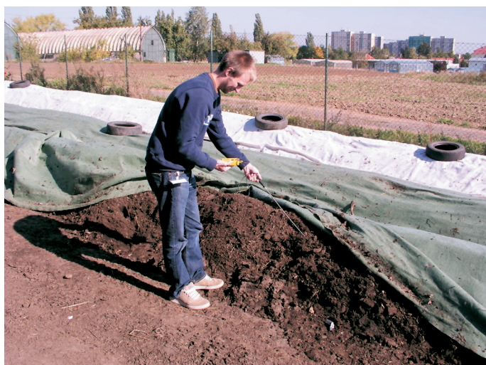
Obrázek 3: Měření a ruční zaznamenávání odečtených hodnot teplot do tabulek
