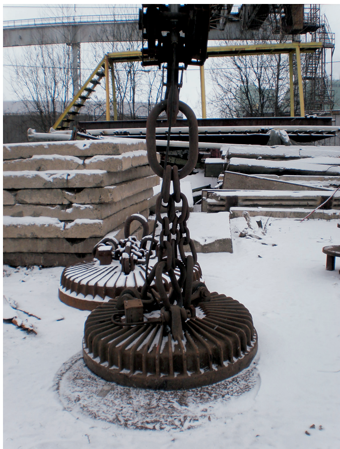
Závěsný magnet má nosnost 20 tun
