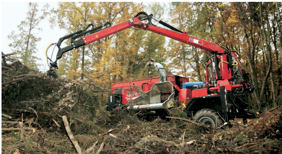
Obrázek 10: Samojízdný štěpkovač (výkon motoru 300 kW)
