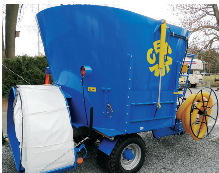
Obrázek 7: Drtič – míchač využívaný jako mobilní kompostárna
