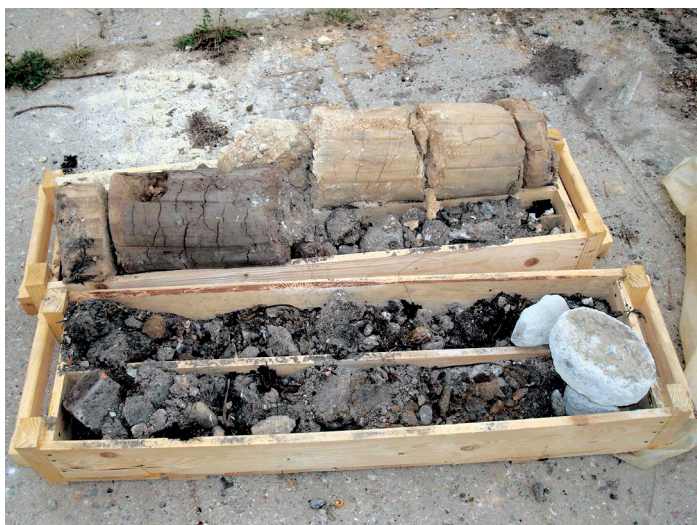
Obrázek 1: Nehomogenní navážky a špatně propustné jílovce ve vrtném jádru indikují, že jde o obtížně sanovatelnou lokalitu
