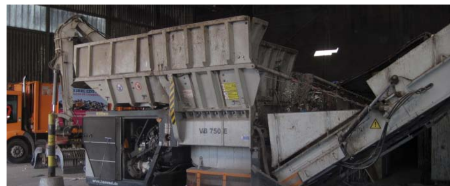
Drcení odpadů drtičem fy. Hammel VB750 E s elektrickým pohonem.
