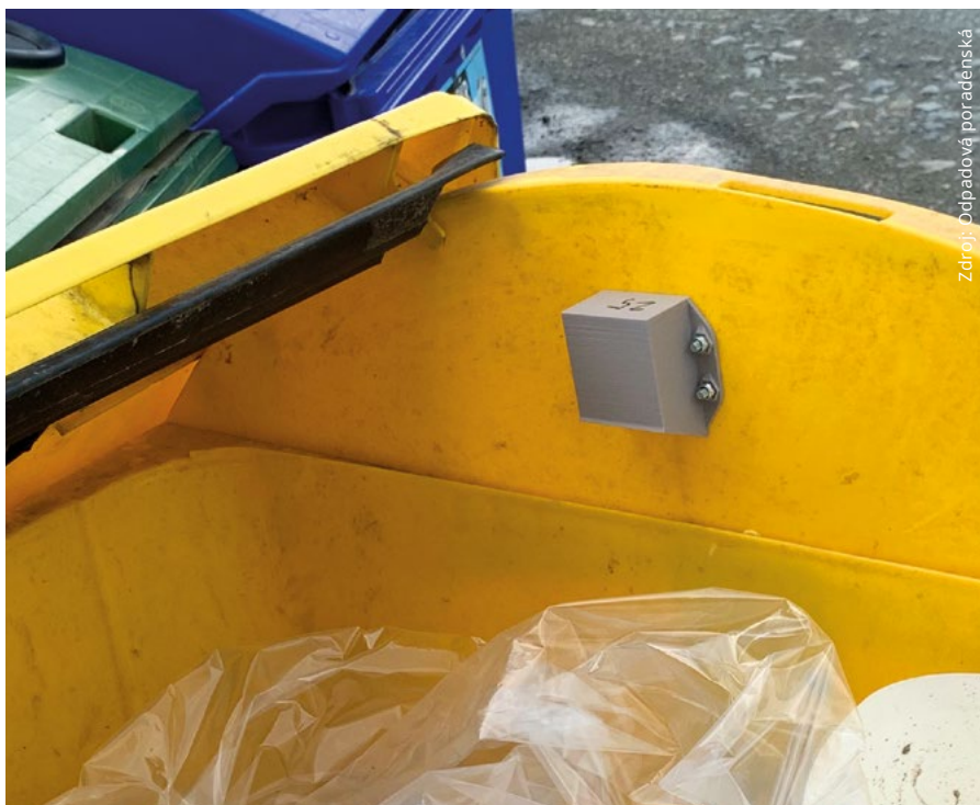
Umístění senzoru monitoringu zaplněnosti v kontejneru 1 100 l
