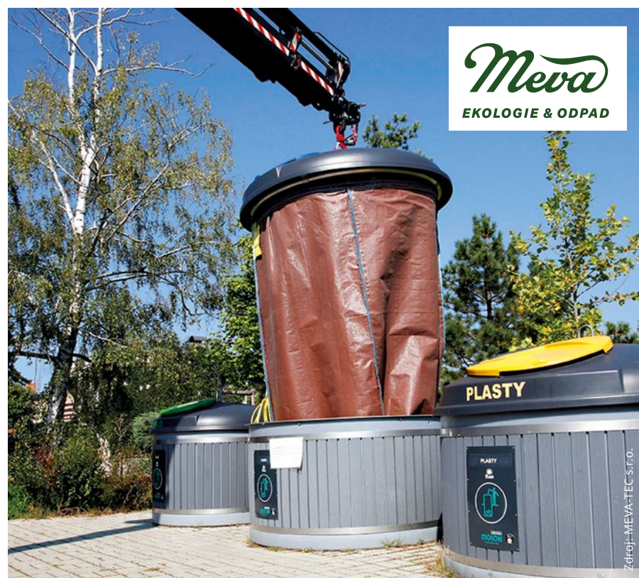
Výklop polopodzemního kontejneru
