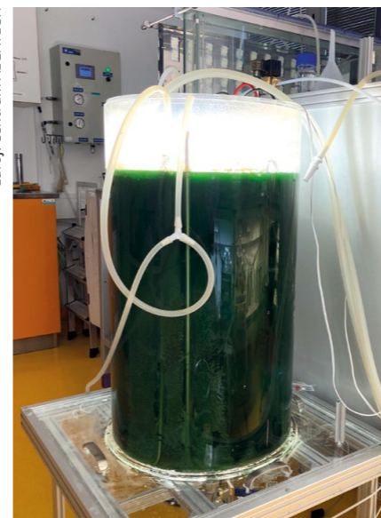
Obr. 2a: Růst sinice Synechocystis sp. ve fotobioreaktoru. Zdrojem živin je odpadní voda z mlékárenské produkce
