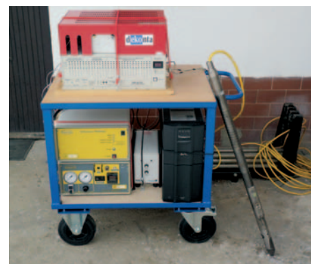
▲ Obrázek 1: Ukázka zařízení EC/MIP s řídicí jednotkou a plynovým chro- matografem
