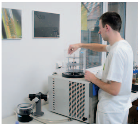
Obrázek 2: Lyofilizátor – uchování jednotlivých kmenů či konsorcií
