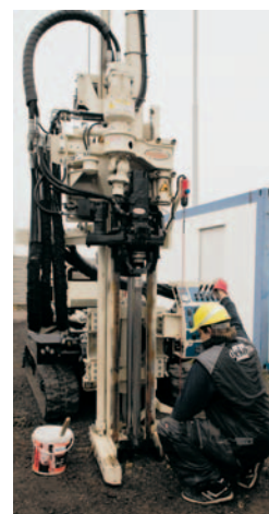
▲ Obrázek 1: Ukázka zařízení EC/MIP s řídicí jednotkou a plynovým chro- matografem
