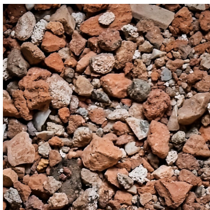
Výroba transportbetonu z cihelného recyklovaného kameniva
