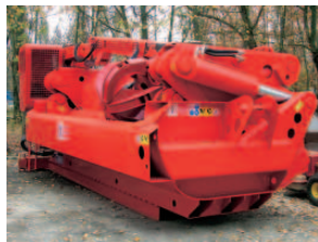
Kontejnerový paketovací lis ARIETE 480/2400
