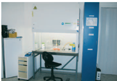
Obrázek: Pracoviště aseptické práce vybavené laminárním flowboxem
