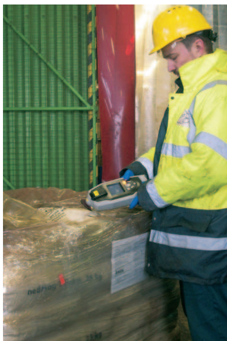
Obrázek 3: Přenosný Ramanův spektrometr usnadňuje identifikaci chemických látek v odpadech
