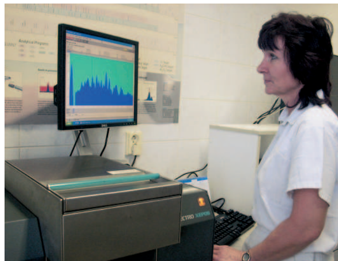
Obrázek 2: Sledování množství chloru, síry a těžkých kovů pomocí XRF spektrometru Spectro Xepos
