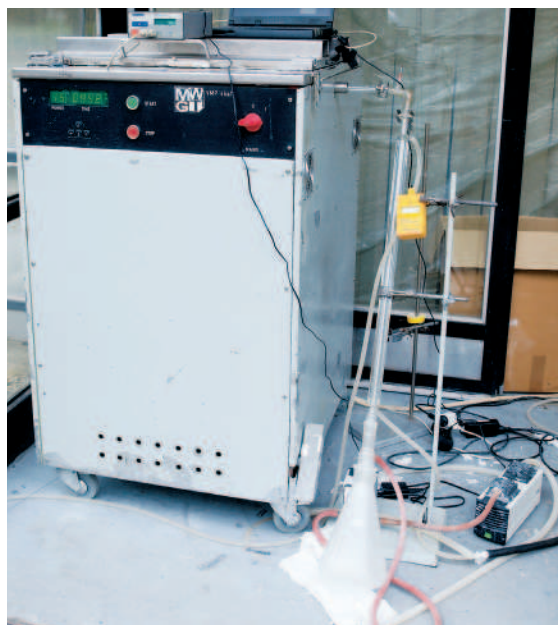
Obrázek 3: Experimentální čtvrtprovozní mikrovlnná jednotka v laboratoři mikrovlnné chemie Ústavu chemických procesů AV ČR.
