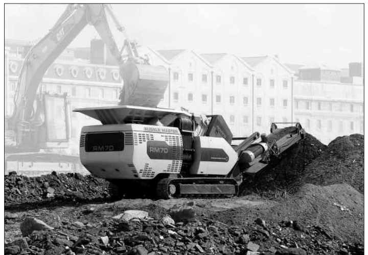
Drtič RM70 je ideální pro nasazení na malé a střední stavby v centrech měst a v bezprostřední blízkosti obytných zón.
