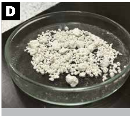
Obrázek 1: a) Prvotní surovina pro recyklaci, b) oseparovaný papír, c) jemnější frakce vzniklého recyklátu, d) hrubší frakce vzniklého recyklátu.
