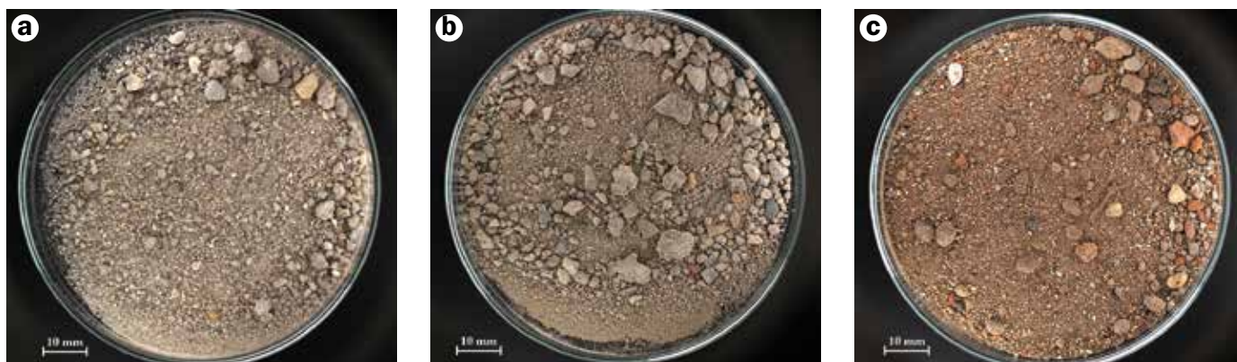
Obrázek 1: Testované recyklované betonové kamenivo: (a) NA; (b) RA 1; (c) RA 4.
