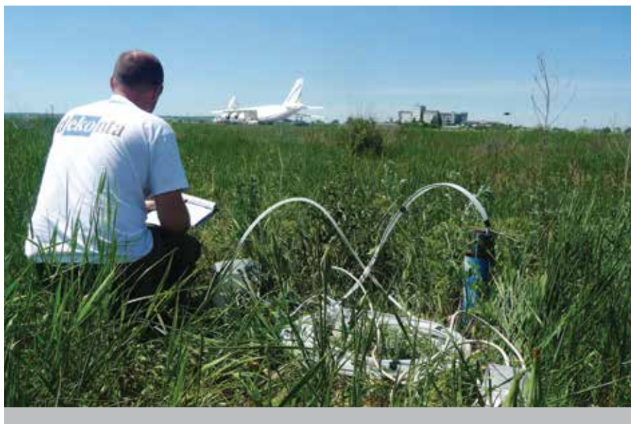
Odběr vzorků podzemní vody z hydrogeologického objektu v prostoru letiště Mărculești
