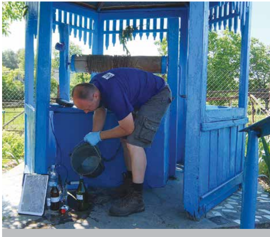
Odběr vzorku podzemní vody z veřejně přístupné studny
