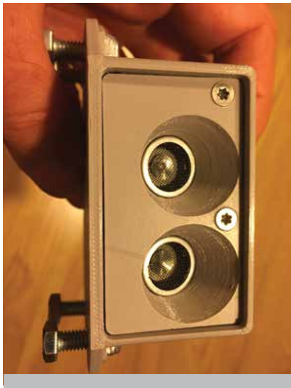
Obrázek 2: Ultrazvukový senzor pro monitoring zaplněnosti kontejnerů 1100l.
