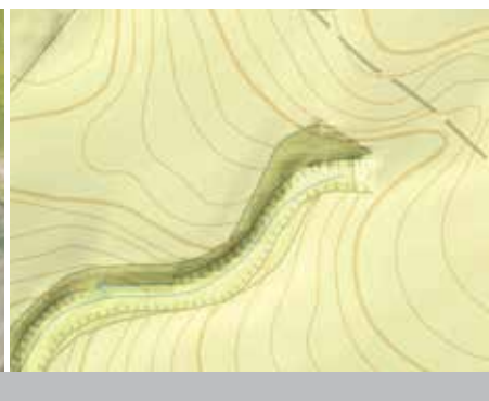
Obrázek: Příklad černé skládky, vlevo na aktuální ortofotografii a vpravo před založením – v topografické mapě v prolnutí s digitálním modelem reliéfu DMR 5G.
