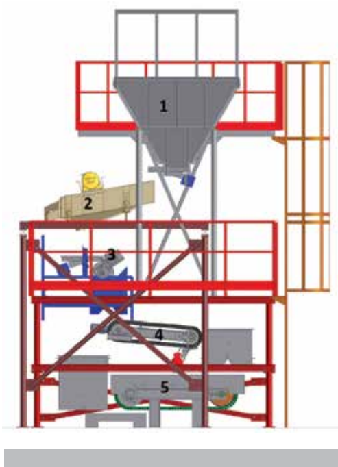
Separátor vířivých proudů: 1 – násypka, 2 – vibrační třídič, 3 – bubnový magnetický separátor, 4,5 – separátor vířivých proudů
