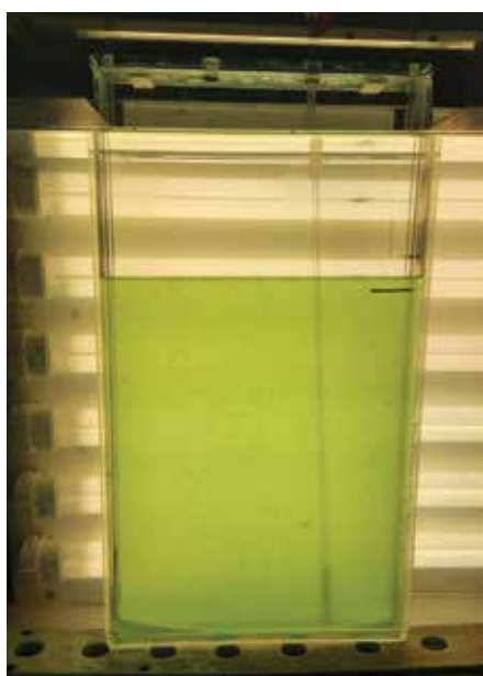
Obrázek 2: Fotobioreaktor. Zařízení na pěstování mikrořas v tekutém živném médiu.
