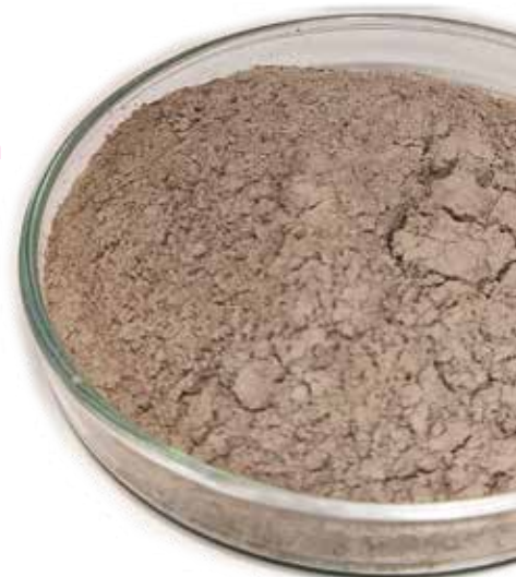
Obrázek 1: Luminofor. Prášek získaný z použitých zářivek, obsahující vzácné kovy.
