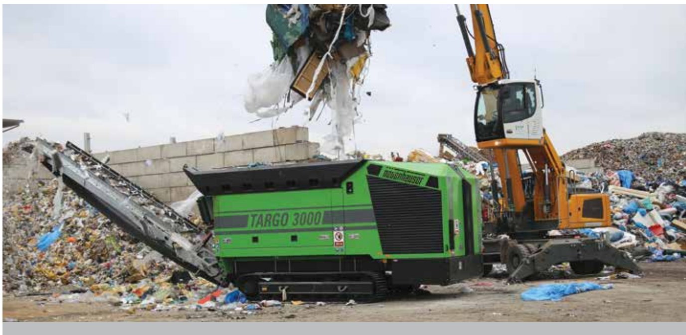
Obrázek 2: Drcení odpadů jednohřídelovým drtičem TARGO 3000.
