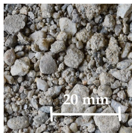
Obrázek 2: Jemné recyklované kamenivo použité pro betonáž (vlevo fRA 0/4 mm, vpravo fRA 0/4mm)
