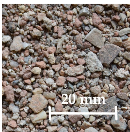
Obrázek 2: Jemné recyklované kamenivo použité pro betonáž (vlevo fRA 0/4 mm, vpravo fRA 0/4mm)
