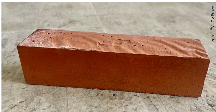
Obrázek 1: Vzorek AAM na bázi cihelného prachu
