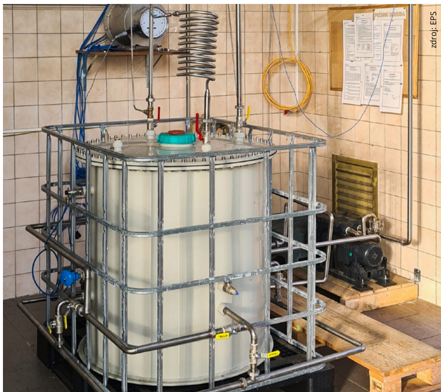
Poloprovozní bioreaktor pro biokonverzi oxidu uhličitého na methan in situ
