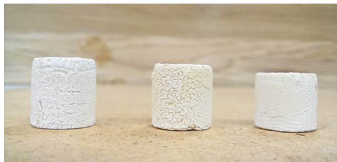
Obrázek 2: Pelety z popílku po klimatizaci v prostředí s teplotou vzduchu 20 °C a relativní vlhkostí vzduchu 65 %
