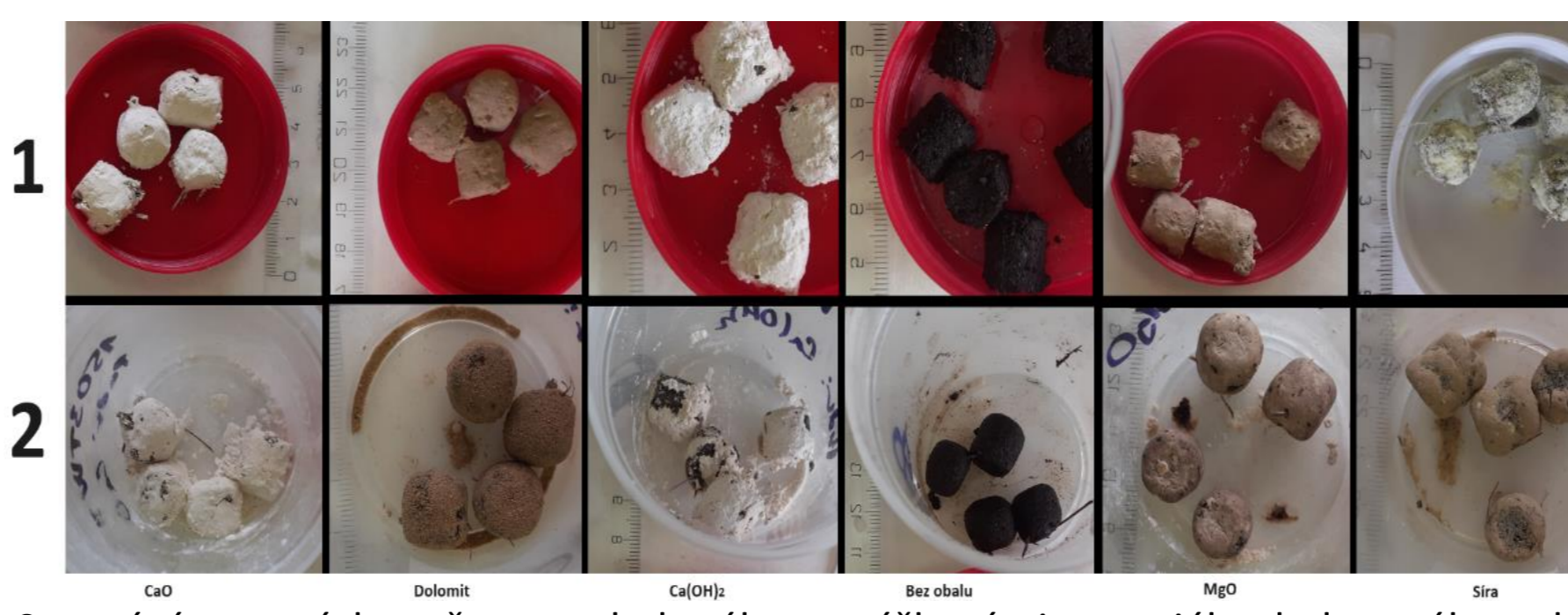
Srovnání tvarových změn u neobaleného a práškovými materiály obalovaného gelu získaného aplikací hydrofilních sorbentů na fugát po stabilním testu s použitím laboratorní třepačky.
