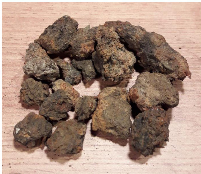
Obr. 7: Kolmatace pláště vrtu, goethitem impregnovaný pískovec
