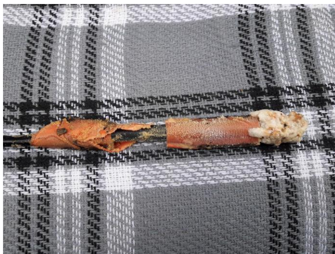
Obr. 10: Kalcifikací (bílé nárůsty vpravo) postižená elektroda
