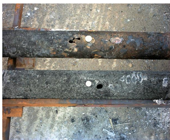
Obr. 15: Prokorodované odpadové potrubí, zdroj úniku ropných látek.
