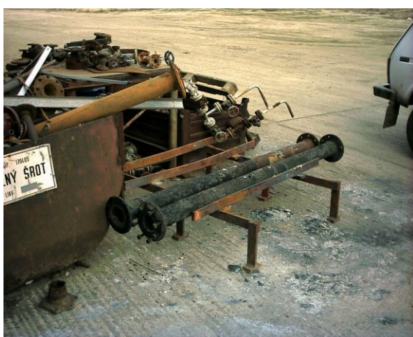
Obr. 15: Prokorodované odpadové potrubí, zdroj úniku ropných látek.
