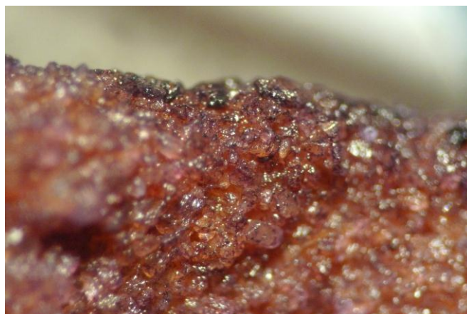
Obr. 12: Vzorek ze stěny vrtu, rezavá - oxo-hydroxidy železa, fialová mikroorganismy.
