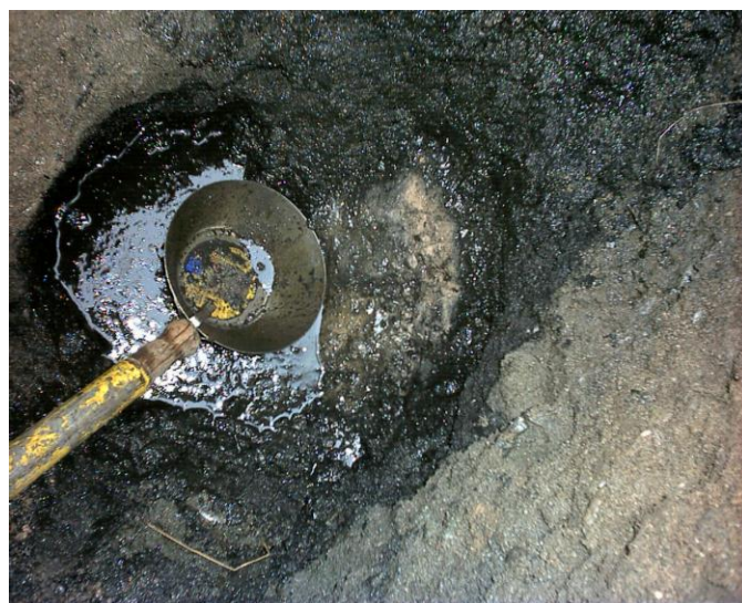
Obr. 8: Produkty oxidace (černé asfalty) na povrchu volné fáze ropných uhlovodíků
