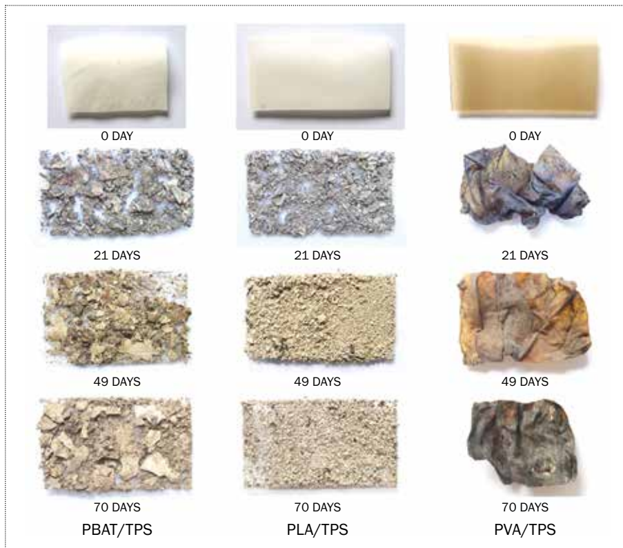
Ukázka výsledků kompostovacího testu PBAT/TPA v porovnání s PLA/TPS. Zdroj: Taiatele et al. 2019
